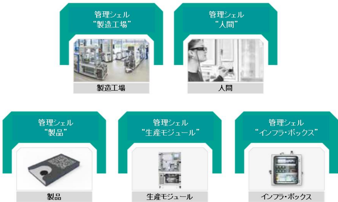
図 6: SmartFactoryKL モデル工場における I4.0 コンポーネントの例
