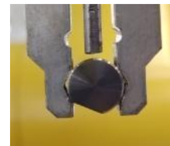
上: 丸ベルト 外径 \phi 4 下: シャフト 外径 \phi 10
