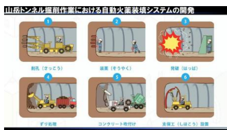
図4 山岳トンネル掘削における自動火薬装填システム（削孔から発破までの6工程）
