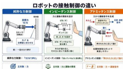
図2 ロボットの接触制御の3方式（純粋な力制御・インピーダンス制御・アドミッタンス制御）
