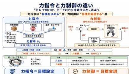
図1 力指令と力制御の違い：力指令は目標設定、力制御は目標実現
