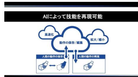
図5 AIによって人の技能（力加減）を保存・編集・再現する仕組み
