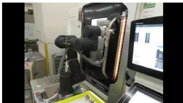
図4 ワーク供給・排出（ドア開け／締め）
