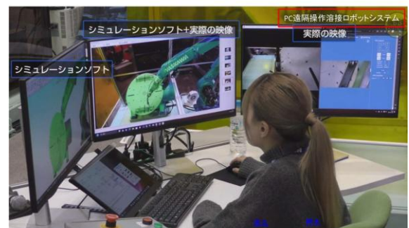
図10 溶接作業教示デバイス「ウェルデモート」の操作画面
