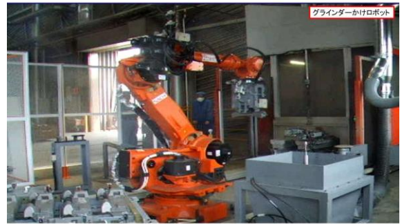
図6 発想を転換したグラインダーがけロボット
