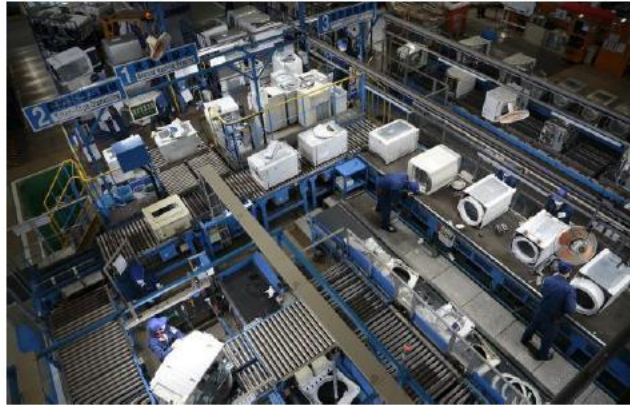
洗濯機解体ライン
