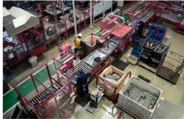
薄型テレビ解体ライン
