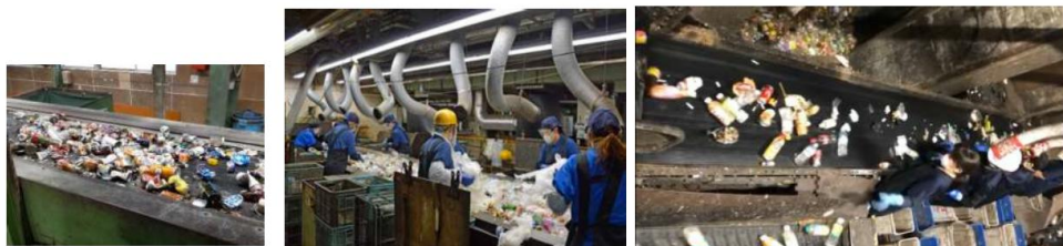
磁選、アルミ選、光学選別後 ⇒PET選別 (内容物入り)、びん色選別 (茶、白、ミックス)
