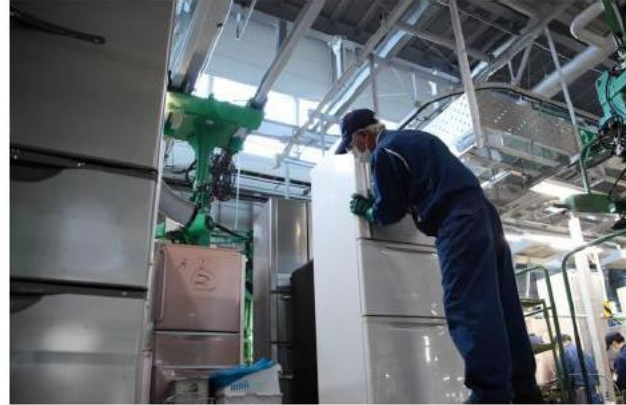
冷蔵庫解体ライン
