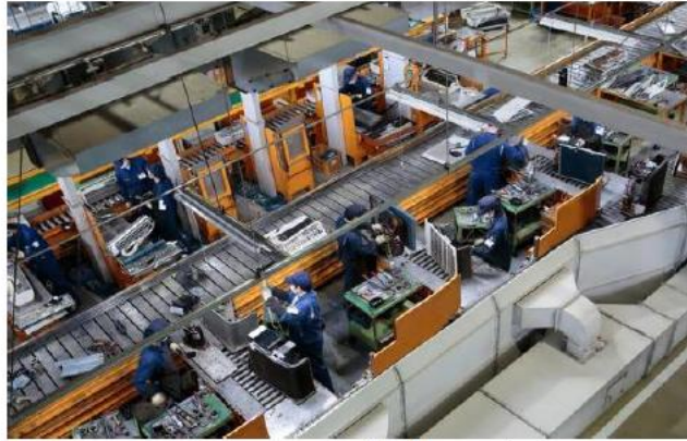
エアコン解体ライン
