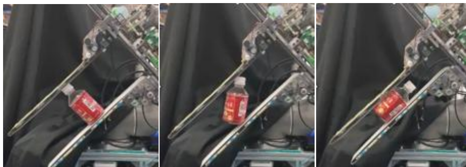
ベルトで商品を回転させる インハンドマニピュレーションが可能
