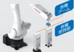
ツールチェンジャーで各商品に最適な把持を選択
