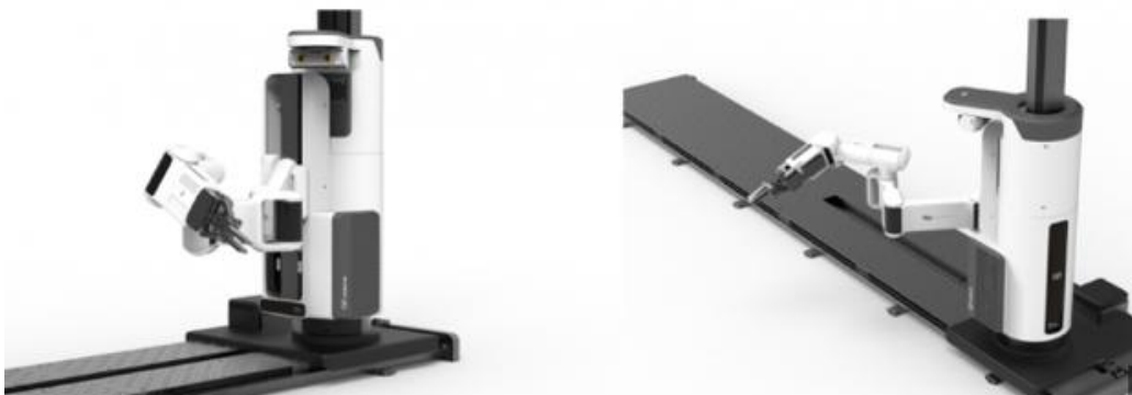
独自の直動軸 + スカラロボット構成
