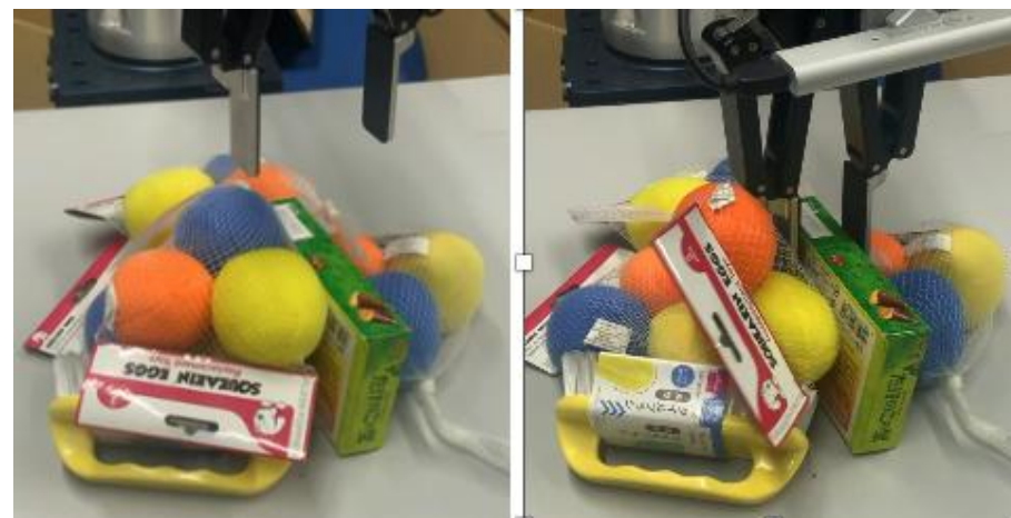
図. 柔らかさ推定方法とピッキング例
