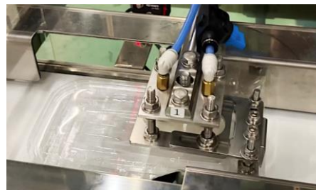
吸着機構に適した容器底面
