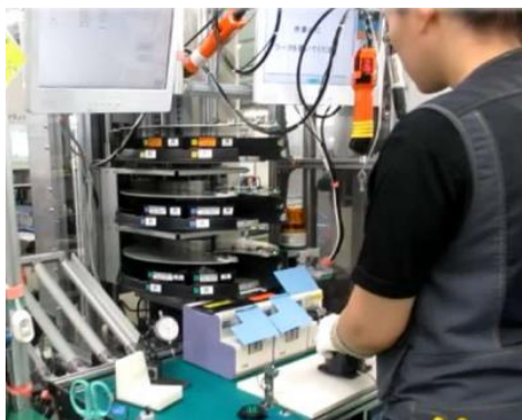
図13 間違わないように支援する設備 (ロータリーディスペンサ)
