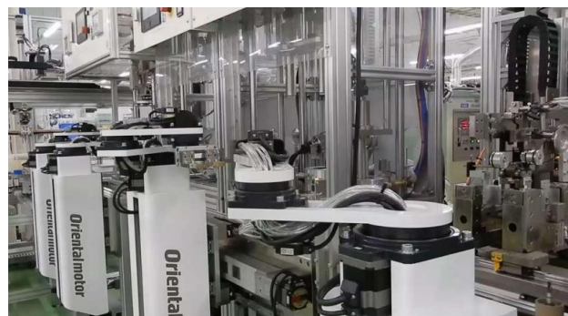
図 1 9 内製スカラ型ロボットを使った自動化
