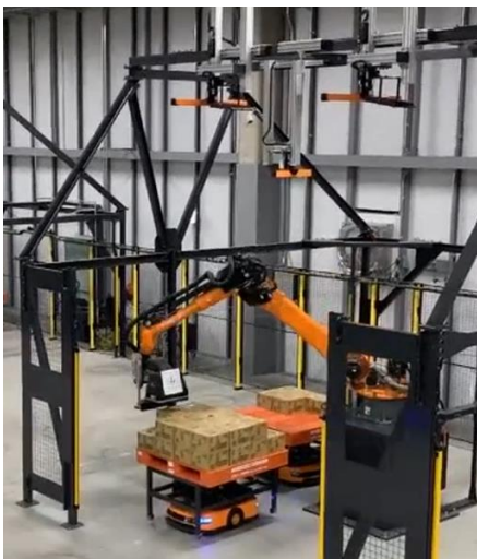
図7 段ボールの自動積み付け（パレタイズ）
